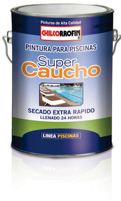
Pintura para piscinas de hormigón nuevas, y repintado, donde el estuco no debe estar aditivado con impermeabilizantes, debido a que ellos actúan como antiadherentes, como tampoco quemarlo con Ácido Muriático, ya que destruye al cemento que es el ligante de la arena, dejando una superficie arenosa, donde las pinturas quedan mal adheridas.
